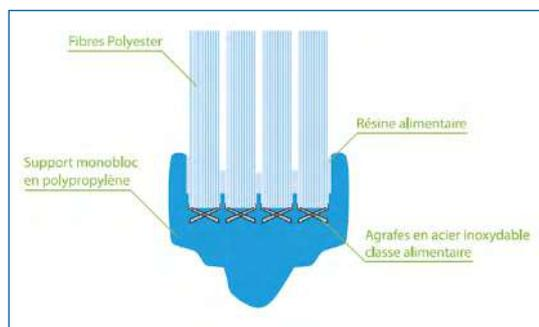
Des fibres solidement fixées grâce à la technologie résine !
