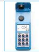
Échelle 1 : 0-9.99 NTU, en 0.01 NTU,  $\pm 2\%$  VM. Échelle 2 : 10-99.9 NTU, en 0.1 NTU,  $\pm 2\%$  VM. Échelle 3 : 100-1000 NTU, en 1 NTU,  $\pm 2\%$  VM.
