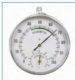
Thermo-hygromètre **à aiguilles**.
