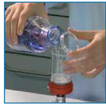
Filter l'échantillon de boisson au travers du Biosart.
