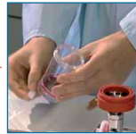
Retirer le Biosart de la rampe. Visser le bouchon sous le Biosart.
