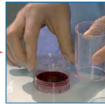
Retirer le corps cylindrique du Biosart afin de le transformer en boîte de Petri.
