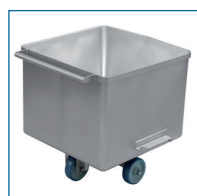
Bacs inox 200 L ou 300 L. Ép. parois 2 mm, fond 2 mm + renforcement 3 mm. Finition décappée, passivée. 2 attaches latérales pour élevateur, poignée, 4 roues en PA. 200 L : 720 x 780 x H 700 mm. 300 L : 720 x 790 x H 950 mm.
